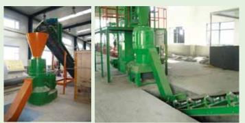
power:>22; flat die diameter (mm):  $\phi$  400,  $\phi$  600,  $\phi$  800 and  $\phi$  1000.
